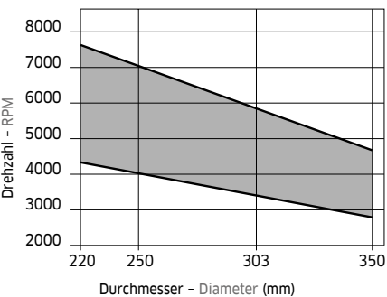
Mindest- und Höchstzahl je nach Blattdurchmesser. Minimum and maximum RPM based on the blade diameter.
